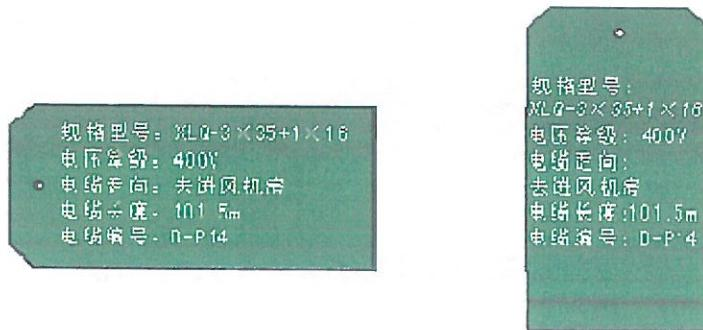
图 34 电缆管线标识牌样式示例
