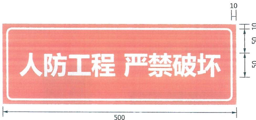
图 36 提示性标识牌样式及尺寸示例
