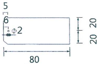
图 35 电缆管线标识牌尺寸示例
