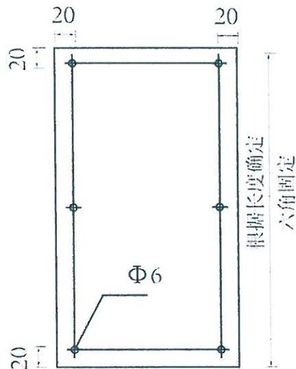
图 2 六孔固定安装示意图
